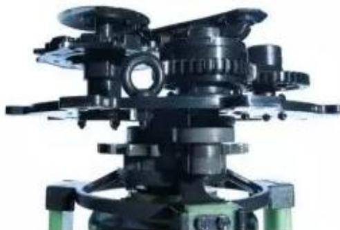
④有载分接开关储能机构采用油灭弧开关成熟的储能机构，驱动可靠。
